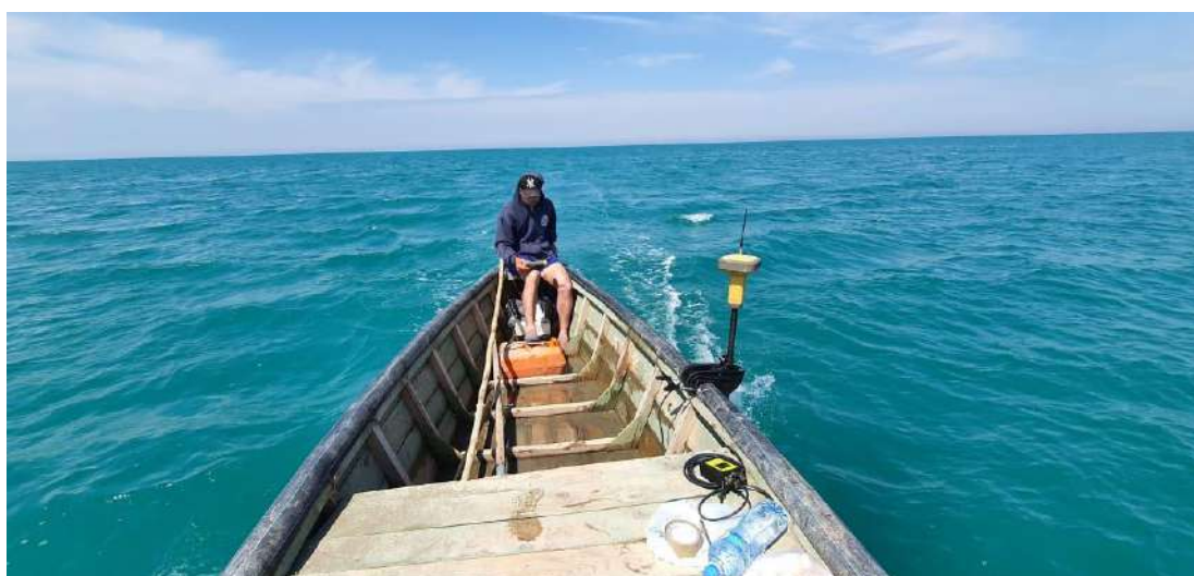
Figura 4. 75 Momente nga procesi i matjeve batimetrike të realizuara në zonën e studimit. (Foto nga Ethem Bejko).
