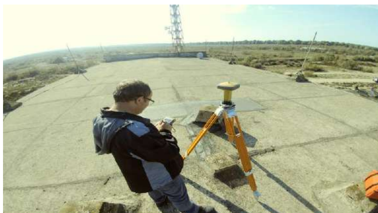
Figura 4. 35 Pika e Rrjetit Gjeodinamik HIDROVORI KARAVASTASË (Pikë e RRGJSH, modeli i fiksimit në taracën e objekteve egzistuese).
