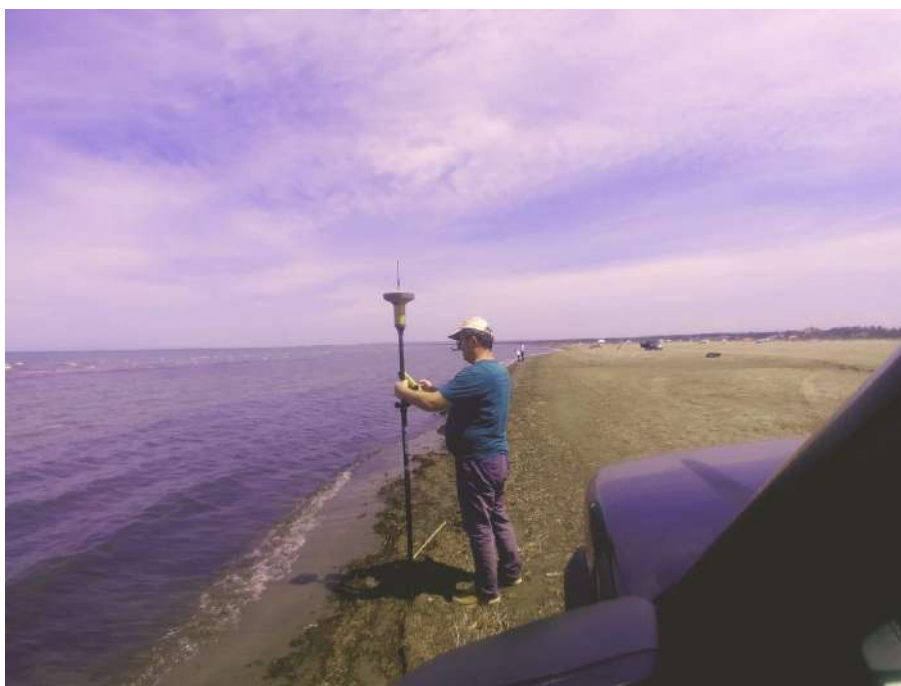
Figura 4. 100 Foto nga procesi i gjurmimit të vijës bregore me metodë satelitore të rilevimit RTK
