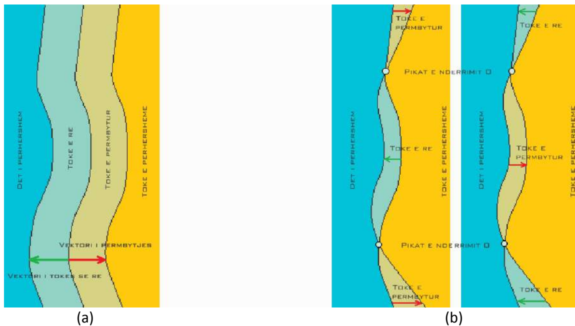
Figura 2. 18 Efekti i spostimit paralel i vijës bregore(a), efekti i spostimit ndërprerës (b)
